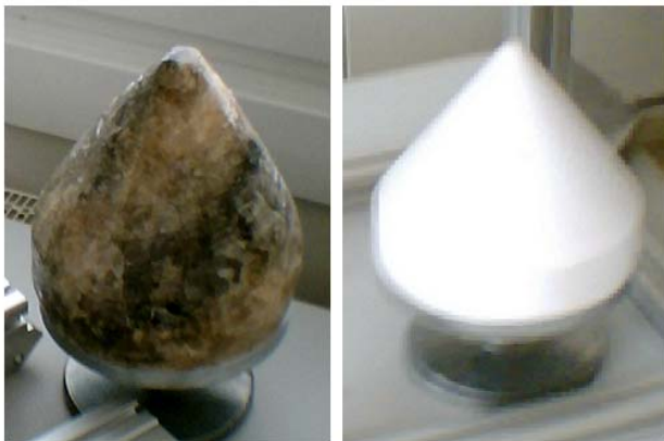
Bilder der Rotationskörper für Experiment 1: Links Salz NaCl, rechts Teflon PTFE
