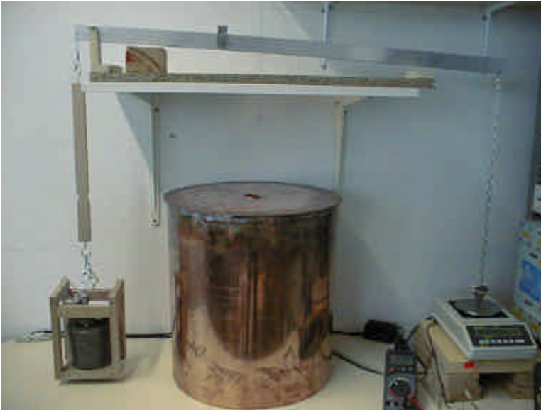
Abb. 10: Wägesystem mit Balkenwaagenkonstruktion (Foto), der Kupferzylinder in der Bildmitte bildet später einen Teil des Faradayschen Käfigs
