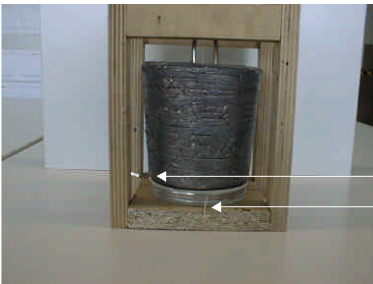
Abb. 11: 13 kg – Gewicht auf Plattenkondensator
