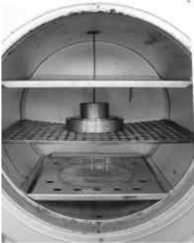
Abb. 3: Presswerkzeug wird zusammen mit Duracap-Granulat erhitzt
