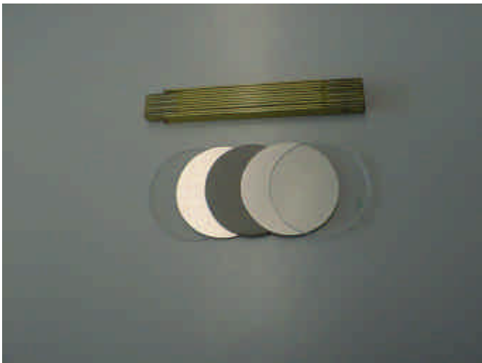
Abb. 7: Einzelteile des Plattenkondensators in korrekter Reihenfolge
