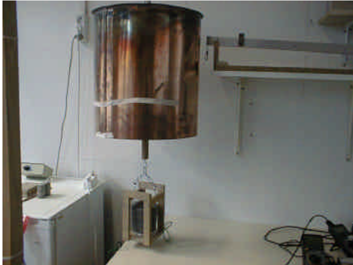
Abb. 12: Anpassen des Kupferzylinders, noch sind die Wire-Wrap-Leitungen nicht verlegt und sind als Leitungsbündel hinten rechts am Hartholz-Rahmen zu erkennen.
