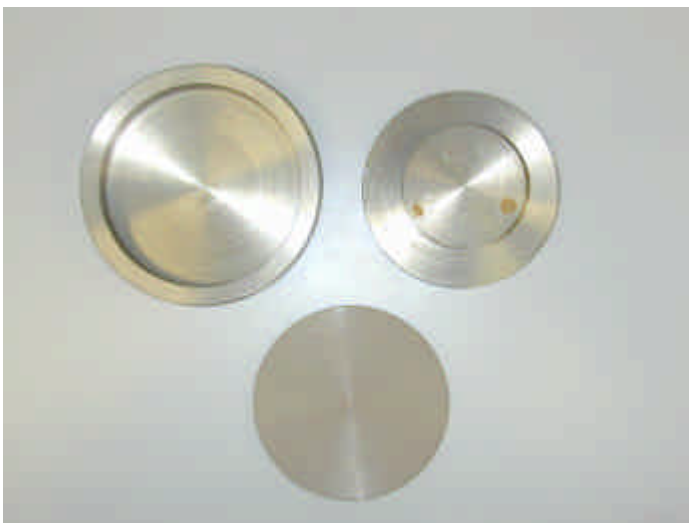
Abb. 5: Unten: Fertig gepresste Duracap-Scheibe, oben: leeres Presswerkzeug
