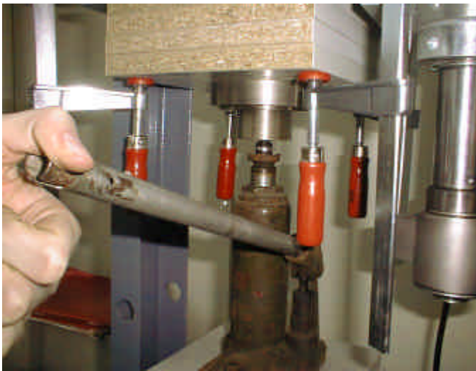
Abb. 4: Pressen des erhitzten Duracap-Materials
